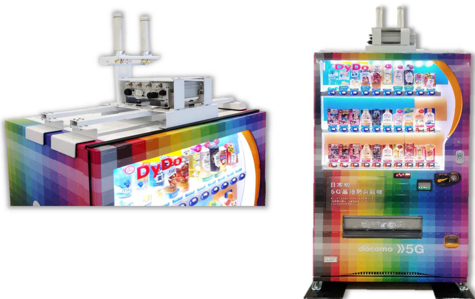
設置予定の 5G 基地局アンテナ（本自動販売機は PR 用のものです）
